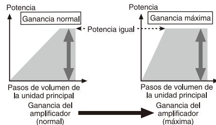
Si la ganancia del amplificador se aumenta incorrectamente, sólo incrementará la distorsión, con un ligero aumento de la potencia.
