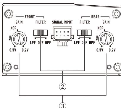
Para ajustar el interruptor, si es preciso utilice un destornillador de cabeza plana.
