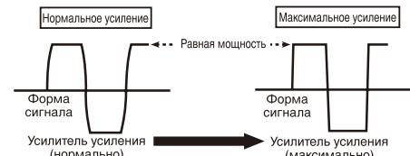
Если при высоком уровне громкости, даже когда коэффициент усиления увеличен, происходит искажение формы сигнала, выходная мощность увеличивается незначительно. □
