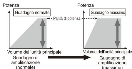
Se il guadagno dell'amplificatore viene regolato su un livello eccessivo, si aumenterà la distorsione, non la potenza.
