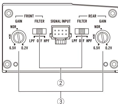
Gebruik indien nodig een platte schroeven-draaier om de schakelaar te verzetten.
