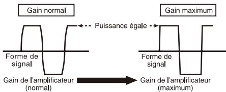
Si la forme de signal est distordue à cause d'une sortie élevée, la puissance de sortie ne sera que légèrement modifiée même en augmentant le gain de l'amplificateur. □
