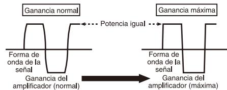
Si la forma de onda de la señal se distorsiona debido a una salida demasiado alta, incluso si se aumenta la ganancia del amplificador, la potencia de salida solo se modificará ligeramente. □
