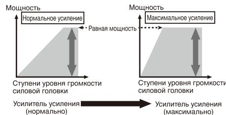
При чрезмерном повышении коэффициента усиления резко увеличиваются искажения, а мощность повышается незначительно.
