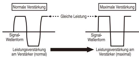
Wenn die Signalwellenform aufgrund einer hohen Ausgabe verzerrt ist, ändert sich selbst beim Erhöhen der Verstärkung des Verstärkers die Ausgabeleistung nur geringfügig.
