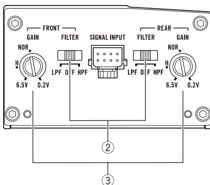
Si nécessaire, utilisez un tournevis plat pour régler le commutateur.
