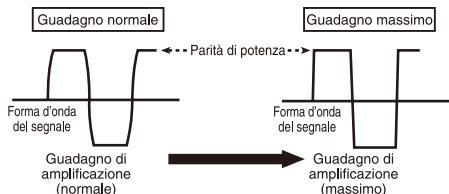
Se la forma d'onda del segnale è distorta a causa del livello di uscita eccessivo, anche se si aumenta il guadagno dell'amplificatore, la potenza in uscita non cambierà significativamente. □
