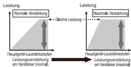
Das unsachgemäße Erhöhen der Verstärkung durch den Verstärker resultiert einfach in mehr Verzerrungen bei geringerer Leistungssteigerung.
