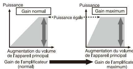
Si le gain de l'amplificateur est augmenté de manière incorrecte, les distorsions augmentent sans que la puissance soit beaucoup plus importante.
