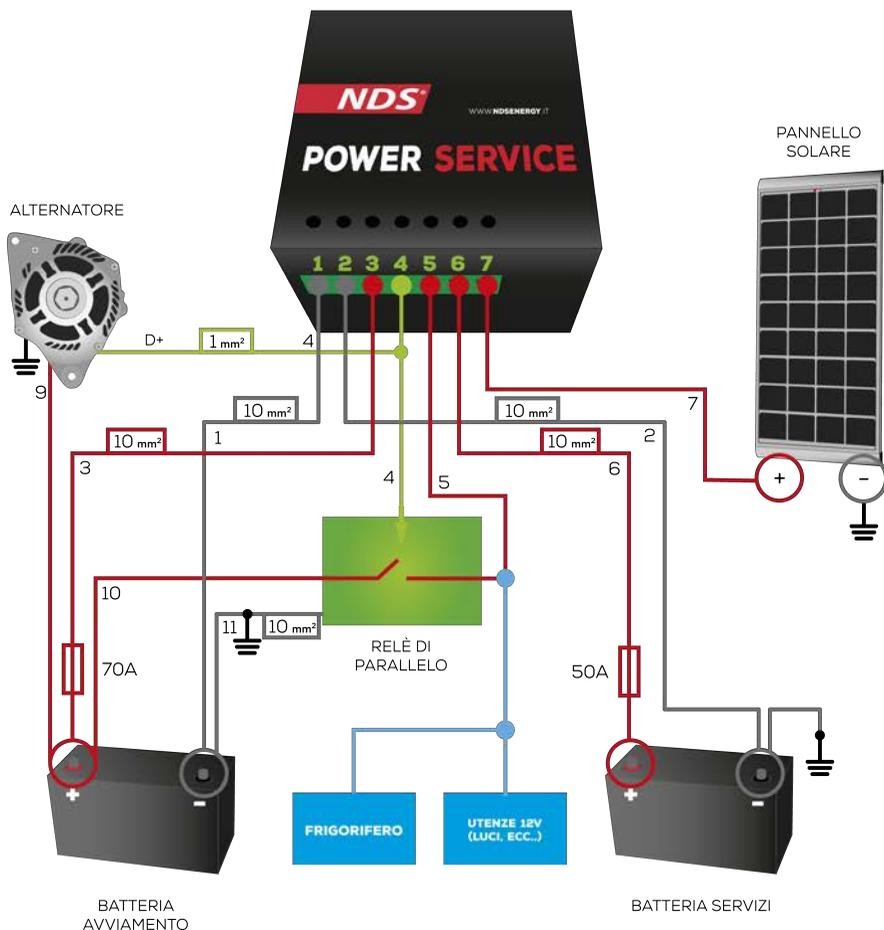
**PER CAVI LUNGI PIÙ DI 2m USARE CAVI DI SEZIONE 16mm<sup>2</sup>**
