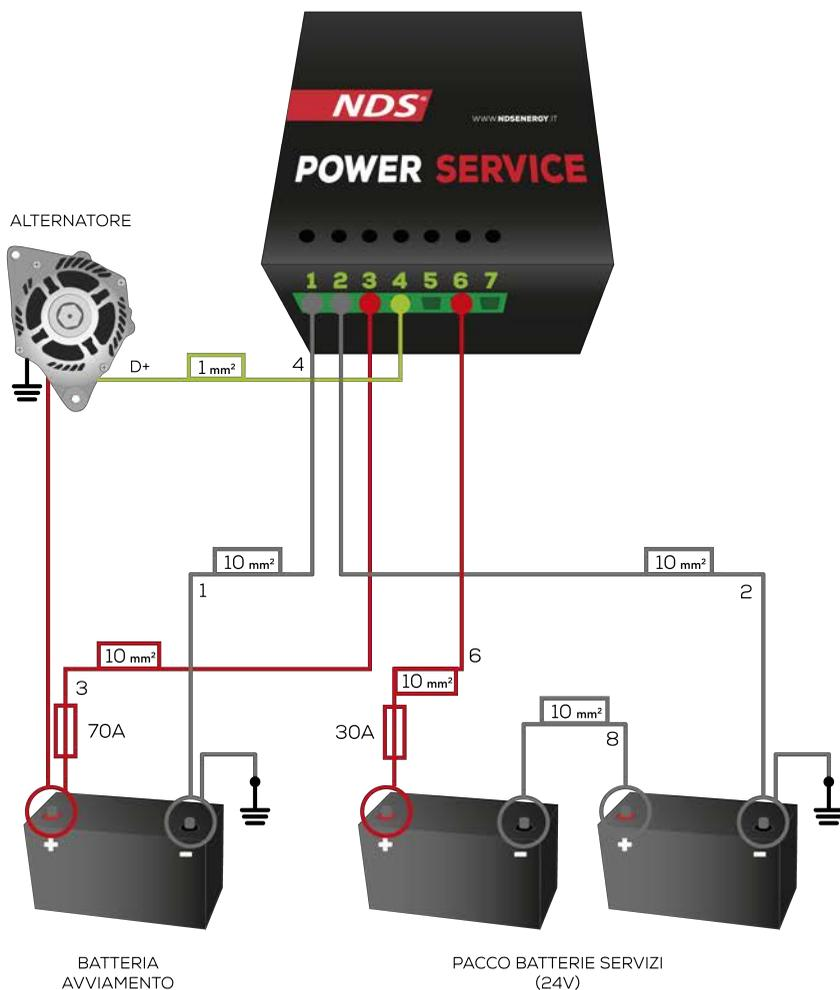
**PER CAVI LUNGI PIÙ DI 2m USARE CAVI DI SEZIONE 16mm<sup>2</sup>**
