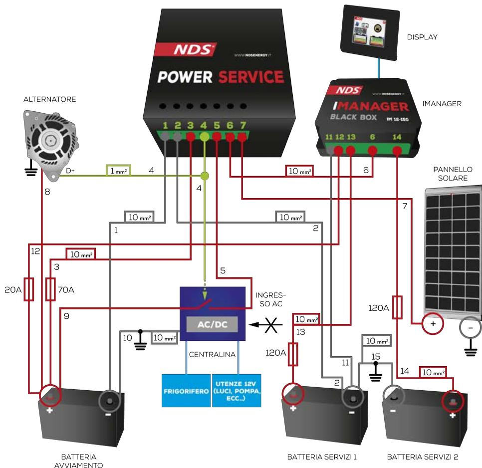
**PER CAVI LUNGI PIÙ DI 2m USARE CAVI DI SEZIONE 16mm<sup>2</sup>**
