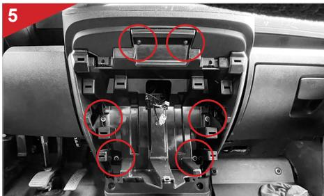
Entfernen Sie die sechs Schrauben (Torx T25) wie oben markiert, um den Konsolenträger entfernen zu können.
