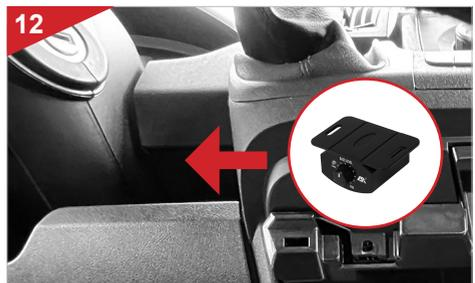
Suchen Sie jetzt einen geeigneten Einbaort für die beiliegende Basspegel-Fernbedienung, z.B. im Fach rechts neben der Lenksäule.
