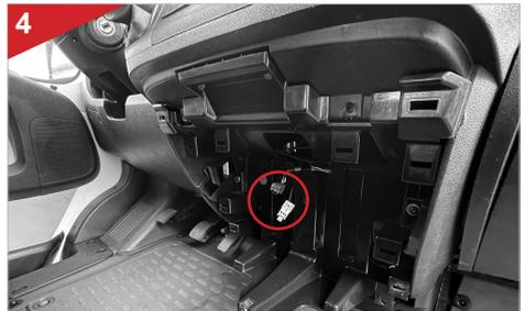
Ziehen Sie falls vorhanden die beiden Anschlussstecker an der Konsole heraus und entfernen diese komplett.
