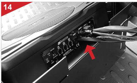
14 Schließen Sie sämtliche Anschlüsse am Subwoofer-System an und nehmen alle Einstellungen vor wie auf Seite 4 beschrieben.
