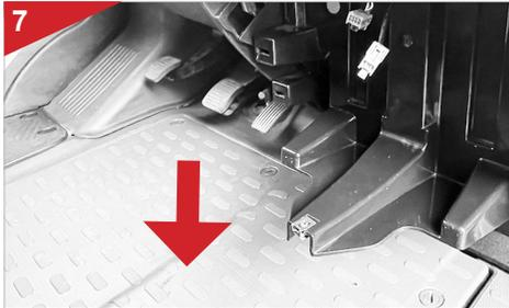
Nehmen Sie jetzt die Abdeckung im Fußraum auf der Fahrerseite heraus. Die zehn Kunststoffschrauben können mit einer Münze gelöst werden.
