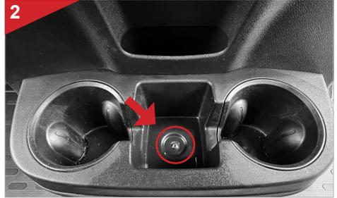
Entfernen Sie die Gummieinlage in der Mitte des Getränkehalters. Lösen Sie dann die Schraube (Torx T25) in der in der Mitte.
