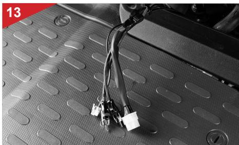
13 Schließen Sie die Cinch-Anschlüsse und die Einschaltleitung am Radio/Navi an und führen die Kabel samt Basspegel-Fernbedienung-Anschluss nach unten.
