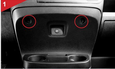
Lösen Sie die beiden Schrauben (Torx T25) oberhalb des Getränkehalters.
