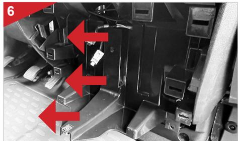
Entfernen Sie dann den Konsolenträger und legen diesen beiseite.
