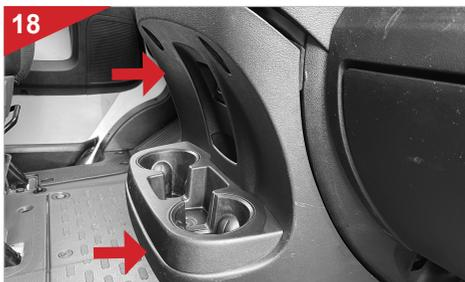
18 Setzen Sie jetzt die Konsole des Getränkehalters wieder ein, wie unter Abschnitt 1 und 2 beschrieben in umgekehrter Reihenfolge.
