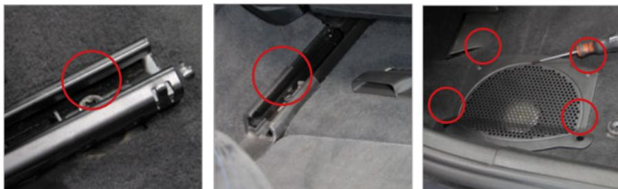
Zum Einbau der Subwoofer müssen die vorderen Sitze ausgebaut werden, welche mit jeweils 4 Schrauben befestigt sind.
