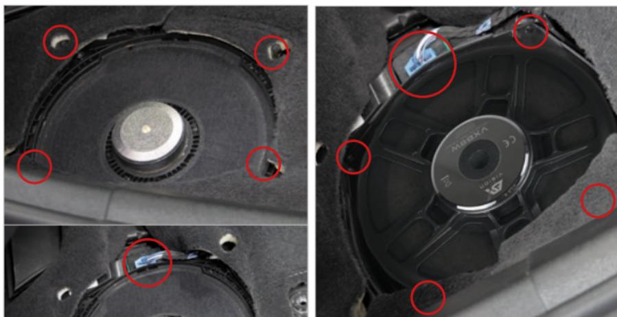
Entfernen Sie nun den Original-Subwoofer, der ebenfalls mit 4 Schrauben befestigt ist und klemmen Sie den Original-Stecker ab. Tauschen Sie dann den Original-Subwoofer gegen den ESX-Subwoofer aus, verbinden diesen mit dem Original-Stecker und schrauben diesen mit den 4 Original-Schrauben fest.
