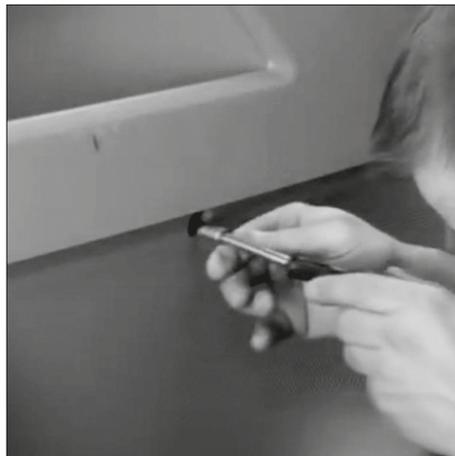
Lösen Sie die Schraube in der Mitte der Türverkleidung.
