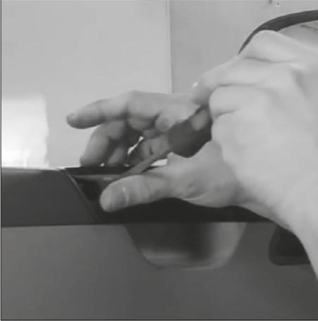
Entfernen Sie die beiden Schrauben des Türgriffes.
