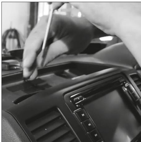
Entfernen Sie dann das Autoradio aus dem Radioschacht.
