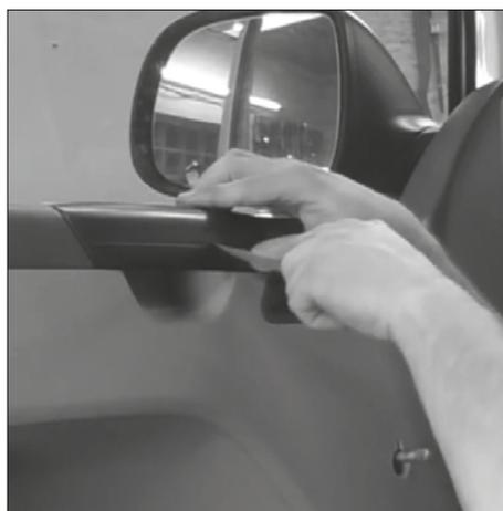
Entfernen Sie die Abdeckung des Türgriffes oben an der Türverkleidung.
