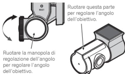
Ruotare la manopola di regolazione dell'angolo per regolare l'angolo dell'obiettivo.
