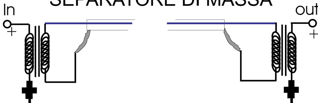
Questa configurazione è indicata per eliminare disturbi derivati da difficoltà di interfacciamento tra apparecchiature collegate tra loro da cablaggi anche corti. L'interposizione del modulo crea una rottura degli anelli di massa tra vari apparecchi collegati con cavi sbilanciati.
