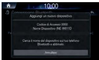
Nel dispositivo Bluetooth, cercare il nome dell'unità AVN e accoppiare il dispositivo. Quando si effettua la ricerca del dispositivo Bluetooth, l'unità AVN compare con il nome "INE-W611D" e il codice di accesso predefinito è "0000".
