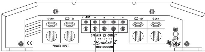
⚠ Optional kann noch ein zweiter Subwoofer an die nicht belegten Anschlussklemmen angeschlossen werden. Dann muss die Impedanz pro Subwoofer 2 - 8 Ohm betragen.
