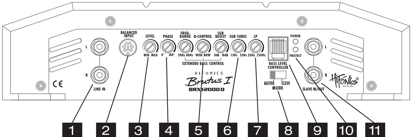
**1** Die **LINE IN**-Cincheingänge zur Ansteuerung mittels Cinch-Kabel mit dem Steuergerät verbinden.
