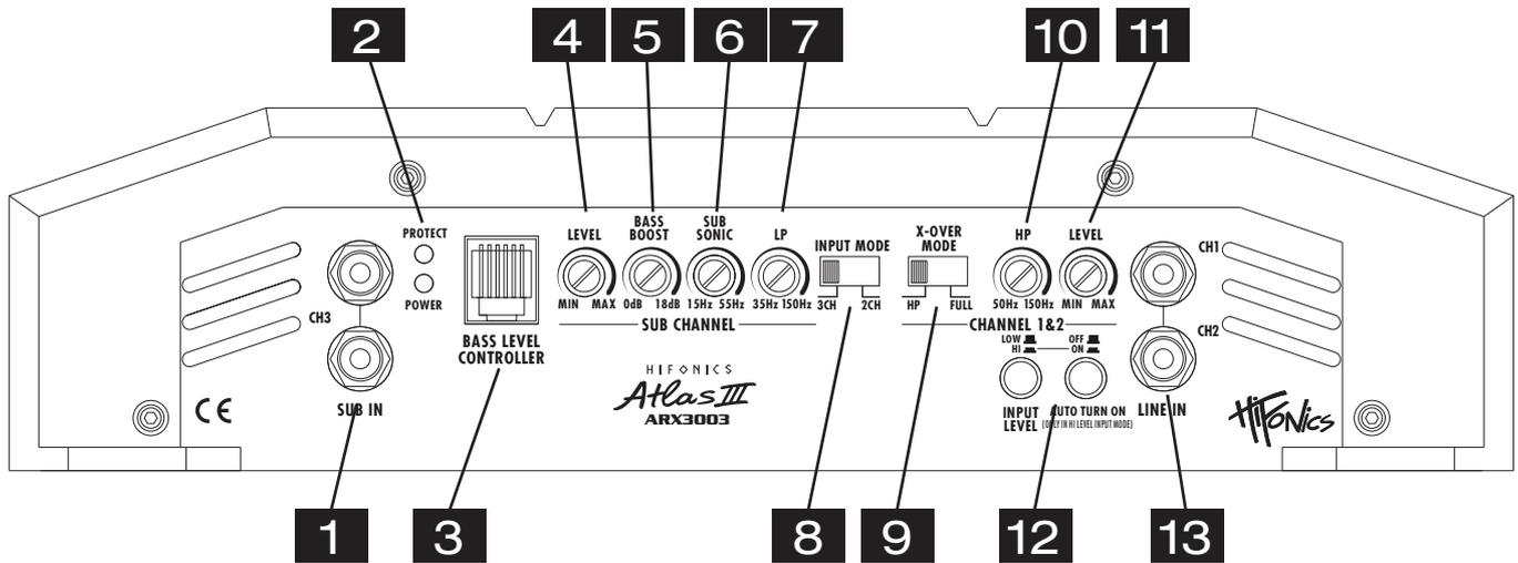
**1** Die **SUB IN**-Cincheingänge zur Ansteuerung mittels Cinch-Kabel mit dem Steuergerät (SUB OUT wenn vorhanden) verbinden. Beachten Sie dazu die Hinweise unter Abschnitt #8.
