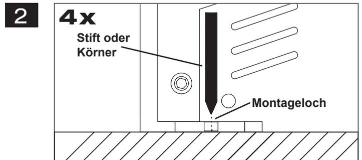
Belassen Sie dann den Verstärker an der gewünschten Einbaustelle im Fahrzeug. Markieren Sie die vier Bohrörter durch das jeweilige Montageloch an den Gussentteilen mit einem geeigneten Stift oder Körner.
