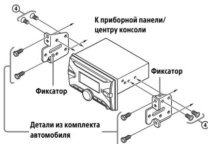
Закрепляя устройство на предварительно установленных кронштейнах автомобиля, вставляйте винты из комплекта ④ в соответствующие отверстия в зависимости от марки автомобиля:
