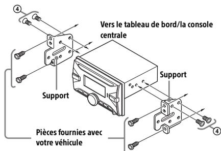
Lorsque vous montez cet appareil sur les supports préinstallés de votre véhicule, positionnez les vis fournies ④ dans les trous de vis appropriés, selon votre véhicule :
