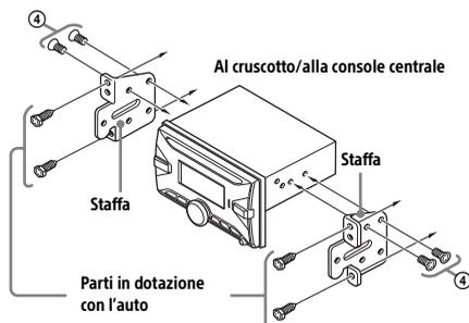
Durante il montaggio del presente apparecchio sulle staffe preinstallate dell'auto, inserire le viti in dotazione ④ negli appositi fori, in base al modello dell'auto:
