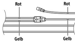
Stellen Sie die Anschlüsse her, schließen Sie die geschalteten Stromversorgungsleitungen richtig an und verbinden Sie dann das Gerät mit der Stromversorgung des Fahrzeugs. Sollten beim Anschließen des Geräts Probleme auftreten oder sollten Sie Fragen haben, auf die in dieser Anleitung nicht eingegangen wird, wenden Sie sich bitte an den Fahrzeughändler.
