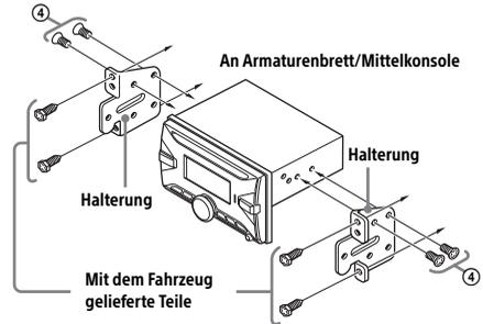
Wenn Sie dieses Gerät an den eingebauten Halterungen des Fahrzeugs montieren, befestigen Sie es mit den mitgelieferten Schrauben ④ in den für den jeweiligen Fahrzeugtyp geeigneten Schraubenbohrungen:
