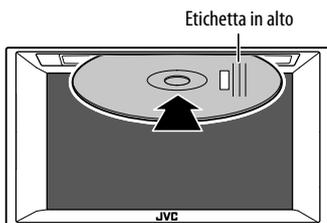
Esempio: inserimento del disco nel modello KW-V240BT
