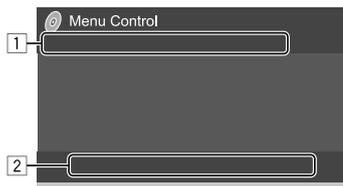
Esempio: schermata di controllo del menu di riproduzione video nel modello KW-V240BT
