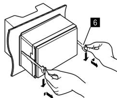
Fare attenzione a non ferirsi con le estremità di presa delle chiavette di estrazione.
