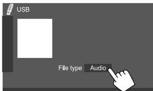
Esempio: schermata di controllo della sorgente USB nel modello KW-V240BT
