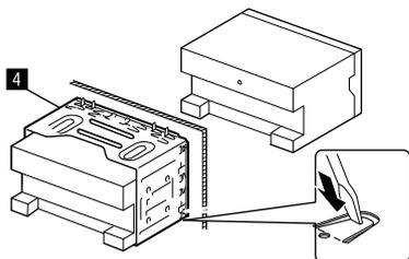
Con un cacciavite o un utensile analogo piegare le linguette del telaio d'installazione per bloccarlo in posizione.
