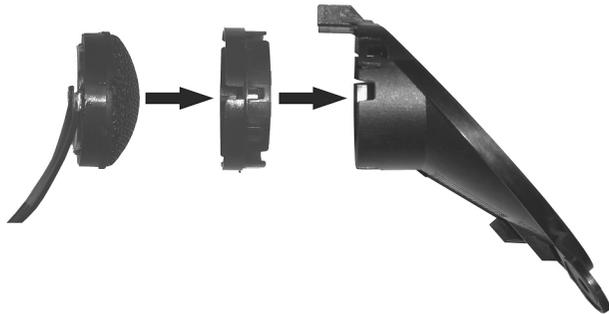
Verbinden Sie den Hochtönerstecker mit dem Originalstecker und montieren Sie in umgekehrter Reihenfolge alles wieder zusammen.
