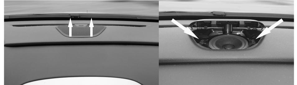
Darunterliegenden Lautsprecher mit 2 Befestigungsschrauben lösen und mit der beigelegten Kabelfrequenzweiche und ETON Lautsprecher austauschen. Ggf. beigelegtes Befestigungsmaterial verwenden.
