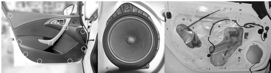
Heben Sie die Türverkleidung zuerst an der unteren Ecke bei den Lautsprechergrittern an. Ziehen Sie die Türverkleidung zu sich und lösen Sie dadurch die dahinter liegenden Klipse. Sie können zum Lösen der Klipse auch Werkzeug (z.B. Schlitzschraubendreher) verwenden. Achten Sie dabei unbedingt darauf, keine Kratzer zu verursachen. Anschließend die Türverkleidung vorsichtig von der Türaußenseite aus dem Fensterschacht heben.
