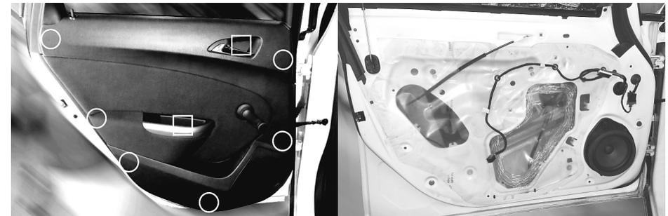
Heben Sie die Türverkleidung zuerst an der unteren Ecke bei den Lautsprechergittern an. Ziehen Sie die Türverkleidung zu sich und lösen Sie dadurch die dahinter liegenden Klipse. Sie können zum Lösen der Klipse auch Werkzeug (z.B. Schlitzschraubendreher) verwenden. Achten Sie dabei unbedingt darauf, keine Kratzer zu verursachen. Anschließend die Türverkleidung vorsichtig von der Türaußenseite aus dem Fensterschacht heben.
