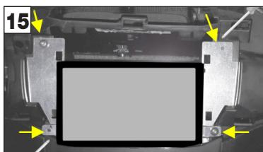
**IT** Montare le staffe metalliche “B” sulla radio (Fig.14). Verificare la corretta posizione della radio in auto ed installare la radio collegandola (Fig.15).
