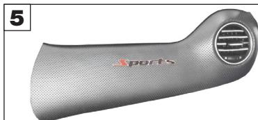
**IT** Estrarre e scollegare pulsantiera e bocchette aria originali (Fig.3). Rimuovere OEM cruscotto prestando attenzione alle due viti Torx T25 poste nel vano porta oggetti (Fig.4). Utilizzando una lama, tagliare il cruscotto OEM lungo la linea curva tracciata precedentemente con la dima "A" (Fig.5).
