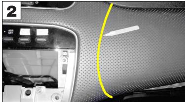
**IT** Rimuovere OEM radio e la gabbia metallica originale. Dopo aver riposizionato il telaio originale in auto, avvitare la dima fornita nel kit "A" come indicato (Fig.1). Seguendo la sagoma della dima, tracciare con una matita la curvatura in corrispondenza (Fig.2).
