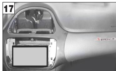
**IT** Assemblare le due parti del cruscotto (Fig.16), montare le n.5 clips sul retro del pannello “C” ed installare il cruscotto al veicolo (Fig.17).
