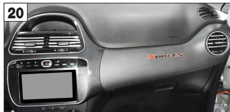
**IT** Collegare la pulsantiera OEM e completare l'installazione del Kit 2DIN (Fig.20).
