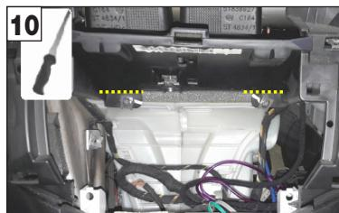
**IT** Tagliare dove indicato nella Fig.6 e nella Fig.10. Rimuovere gli elementi indicati nella Fig.7, Fig.8 e Fig.9. Smontare le prestole originali evidenziate sopra ed utilizzarle in seguito (vedi Fig.13).
