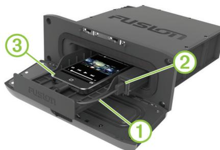
4 Collegare il cavo adattatore al lettore multimediale ③ e posizionarlo nel vassoio del dispositivo.
