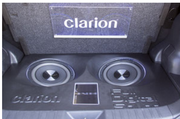
Molto spettacolare (in fondo è un'auto demo) il bagagliaio della Nissan Juke dimostrativa del sistema Full Digital Sound di Clarion. Sono stati impiegati due woofer Z25W che agiscono nello stesso volume di caricamento appositamente dimensionato.
