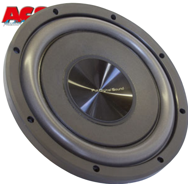
Il possente woofer da 25 centimetri siglato Z25W presenta membrana in polpa di cellulosa rinforzata con fibre minerali, sospensione in foam e cestello (complesso) in pressofusione.
