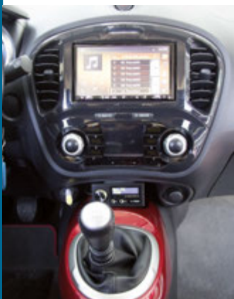
La sorgente utilizzata è una NX706E che offre la possibilità di pilotare direttamente il sistema FDS tramite un'uscita digitale con controllo di volume. Legge anche file in HD. Il controller del processore Z3 è stato inserito subito sotto il monitor.
