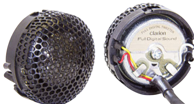
Il piccolo tweeter nella sua essenza. Presenta una cupola da un pollice in seta ed un corto cavetto di collegamento che connette le due bobine di cui è dotato alla driver unit presente nel processore.
