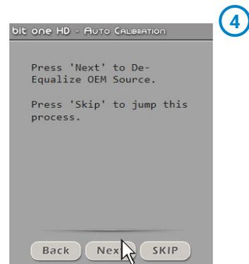
**Es.:** anche se si selezionano esclusivamente gli ingressi Front Left Full e Front Right Full, il software eseguirà la de-equalizzazione anche su Rear, Center e Subwoofer in quanto il processore dovrà utilizzare i segnali identificati come Front per gestire eventualmente anche le uscite Rear, Center e Subwoofer.
