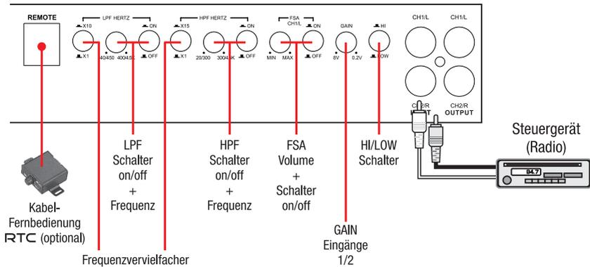
Die **X SERIES** Verstärker besitzen RCA-Eingänge, welche durch Cinchkabel mit den Vorverstärker-Ausgängen des Steuergerätes verbunden werden.
