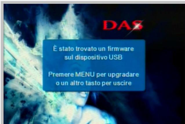
**TASSATIVAMENTE** non spegnere il ricevitore durante l'aggiornamento e non rimuovere la chiavetta USB fino al completamento dell'operazione. Questo provocherebbe il danneggiamento del dispositivo stesso.
