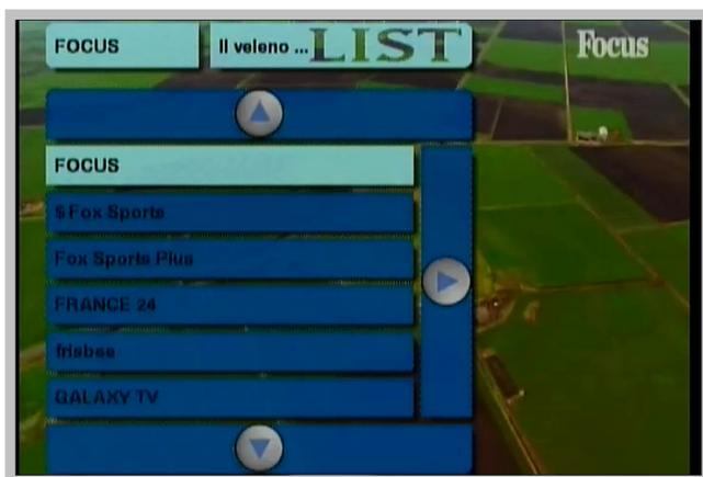
Quando il canale TV è ben visibile, premere in sequenza **“MENU 1-2-3”**. Questa funzione è essenziale per installare le 4 antenne all’interno del veicolo, perché essa guida l’utente a trovare la migliore posizione dove poter fissare le antenne per prendere il segnale disponibile migliore.
