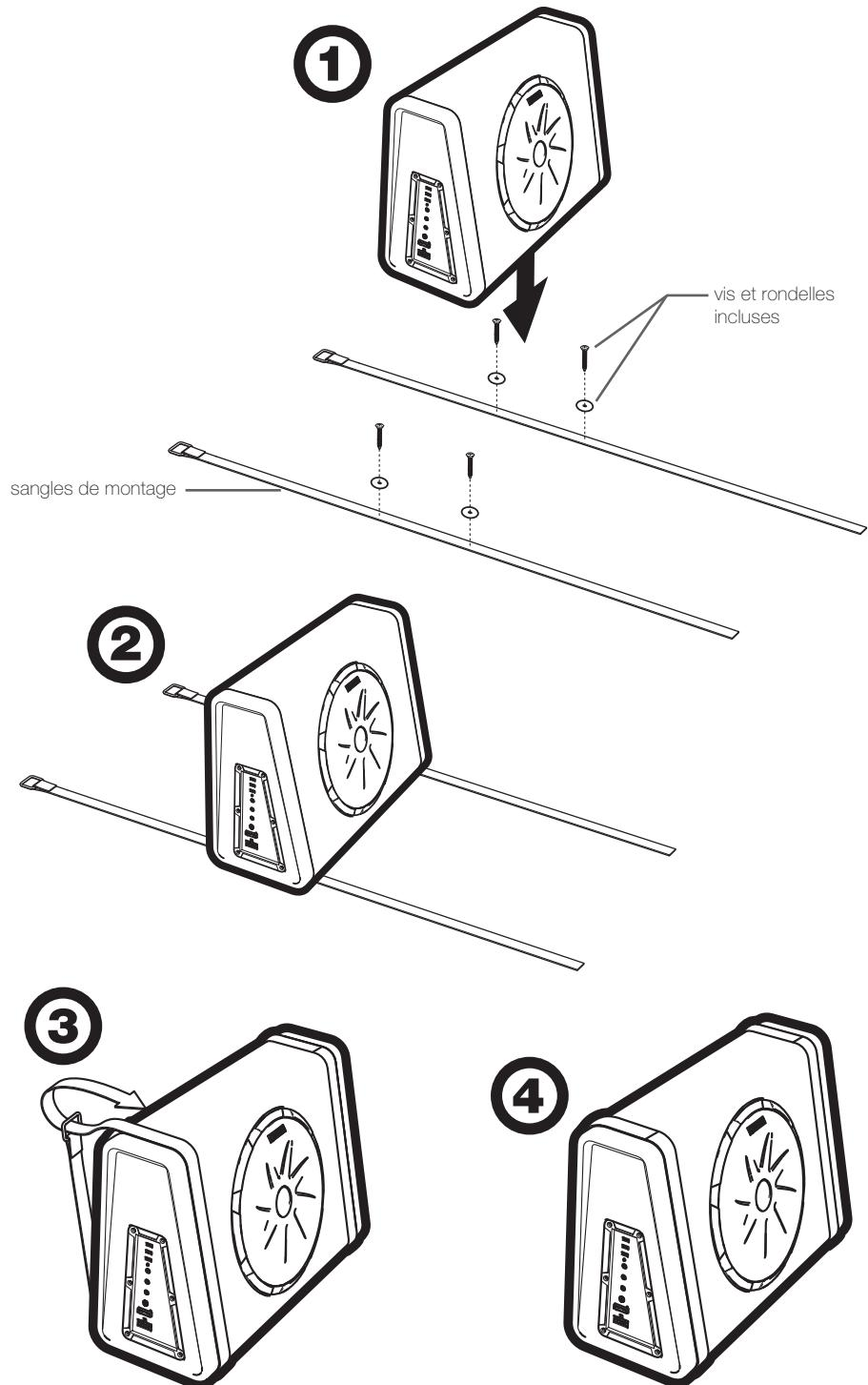
**Si le matériel de montage fourni ne s'applique pas à votre installation, vous devez utiliser un autre moyen d'attacher fixement l'enceinte au véhicule.**
