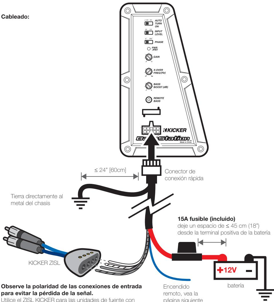
**Observe la polaridad de las conexiones de entrada para evitar la pérdida de la señal.**
