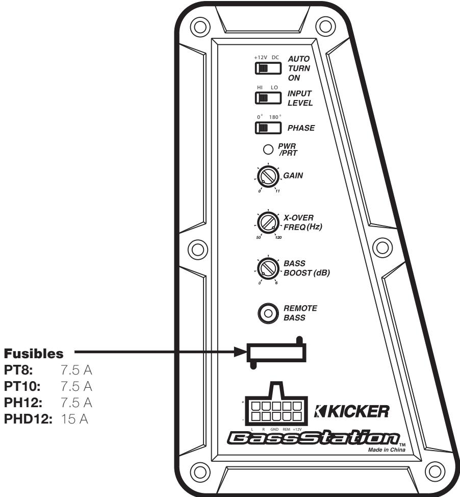
**Sélection de mise en marche automatique :** Les enceintes KICKER proposent deux modes de mise en marche, que vous pouvez sélectionner sur le panneau latéral ; +12V et DC Offset. Le fait d'utiliser le mode DC Offset permet à la borne REM de disposer d'une sortie de +12V pour le branchement d'amplificateurs supplémentaires.
