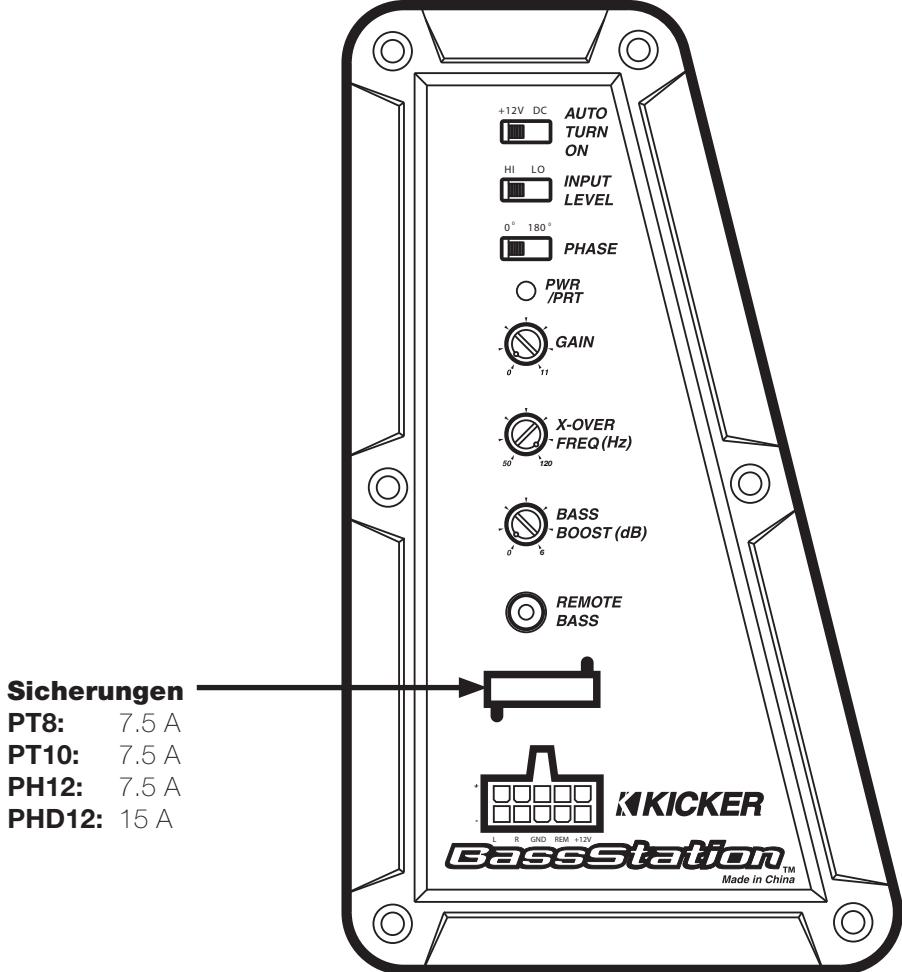
**Automatische Einschaltauswahl:** KICKER Powered Enclosures umfassen zwei automatische Einschaltmodi, die an der Seite ausgewählt werden können: +12V und DC Offset. Der DC Offset-modus aktiviert am REM-Anschluss die +12V Ausgabe für das Einschalten zusätzlicher Verstärker.
