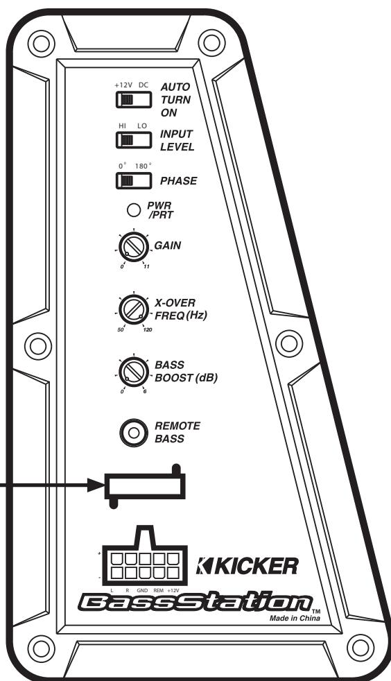
**Selección de encendido automático:** los gabinetes con la tecnología de KICKER ofrecen dos modos distintos de encendido automático que se pueden seleccionar en el panel lateral: +12V y desvío de CD. Usar el modo desvío de CD hace que la terminal REM tenga +12V para encender amplificadores adicionales.
