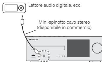
Se il mini-spinotto jack **AUDIO IN** è connesso a una presa jack ausiliaria telefonica, il volume del ricevitore dovrà essere regolato in base a quello del componente di playback. Se il suono è distorto, dopo aver abbassato il volume del ricevitore, cercare di abbassare anche quello sul componente ausiliario di playback.
