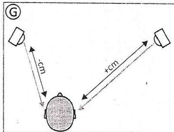
La diversa distanza tra il Tweeter e l'orecchio, a destra ed a sinistra, è causa di sbilanciamento del fronte sonoro. La regolazione asimmetrica dei ponticelli nella sezione A risolve il problema compensando le differenze. Attenua l'emissione del Tweeter di sinistra, riduci il livello di 2dB (es. Sinistra A=3, Destra A=2).
