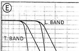
Collegando il Woofer alla uscita T.BAND il filtro limita la risposta dell'altoparlante alla gamma bassa e medio-bassa. Se, si utilizzano i connettori L.BAND, parte delle frequenze emesse dal woofer si sovrappongono a quelle del Tweeter. In particolari condizioni, questo regolazione innalza il fronte sonoro.
