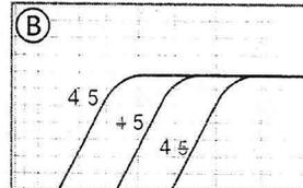
Può rivelarsi conveniente regolare la gamma di frequenze riprodotte dal Tweeter, infatti, sia la posizione, sia l'inclinazione che la distanza dal woofer, incidono sulla resa della gamma media-alta. Usa i ponticelli per modificare la risposta: se per esempio c'è poca distanza tra tweeter e woofer, riduci le medie inserendo il solo ponticello 4.
