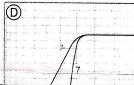
I materiali del cruscotto, il parabrezza ed i montanti, incidono sulla timbrica del sistema acustico, certe vetture creano corto-circuiti e riflessioni imprevedibili quanto deleterie per il suono. Il ponticello 7, quando inserito, accentua l'azione del filtro e limita quelle frequenze che di solito si degradano per le cause descritte sopra.
