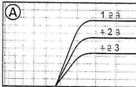
A seconda della posizione in cui lo hai installato, il Tweeter può risultare più o meno presente, regolane il livello di emissione inserendo i ponticelli nelle posizioni: 1 (+2dB), 2 (0dB) o 3 (-2dB). Se, per esempio, lo hai montato in portiera nella predisposizione sotto il deflettore (vicino all'orecchio), scegli di attenuarlo inserendo il ponticello nella posizione 3.
