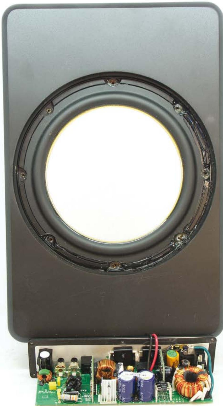
*Il piccolo Macrom messo (quasi) a nudo. L'ampli si rivela molto tradizionale e dalla costruzione un po' caotica, tuttavia compatta ed in linea con le caratteristiche dichiarate. L'altoparlante, qui privato della doppia protezione, è sigillato con del collante per evitare sfiati derivanti dalle forti sollecitazioni a cui è sottoposto.*
