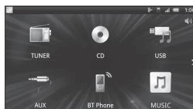
Pour sélectionner une autre source ou application, appuyez sur SRC, puis tournez la molette de réglage pour sélectionner la source ou l'application souhaitée.
