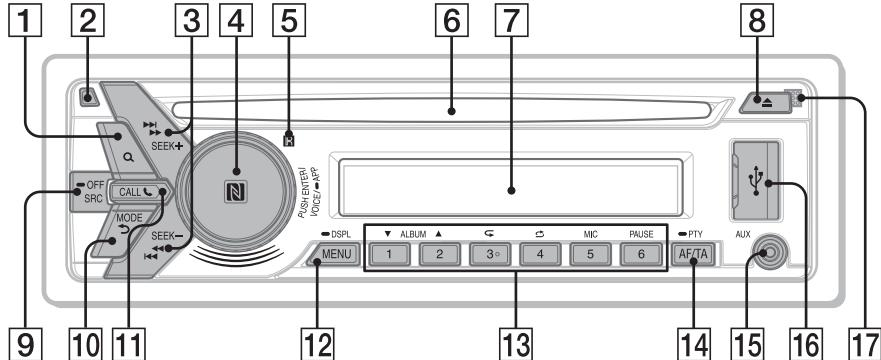
Die Zahlentaste 3/Taste ⏪ (Wiederholen) ist mit einem fühlbaren Punkt gekennzeichnet.
