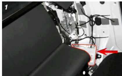
**I** - La porta Audio si trova all'interno del vano passeggeri, dietro al rivestimento sul lato sinistro del sedile posteriore (Fig. 1 e 2).
