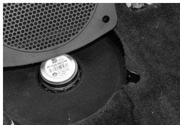
N°14. Le subwoofer d'origine se trouve sous la grille plastique de protection
