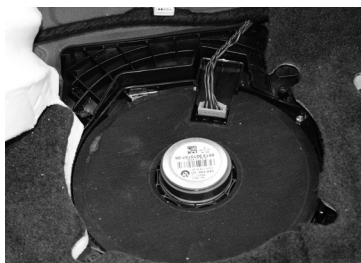
N°16. Subwoofer accessible pour démontage
