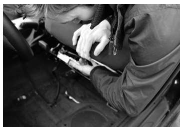
N°8. Une fois les 4 vis démontées, basculez le siège vers l'arrière
