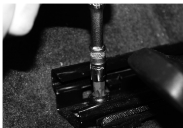
N°5. Dévissez à l'aide d'un embout "torx 45"
