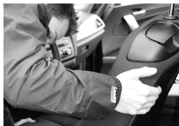
N°6. Avancez le siège pour avoir accès aux vis arrière
