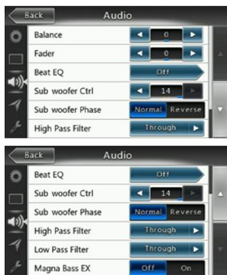
In questo menu sono inclusi: Balance (Bilanciamento), Fader (Dissolvenza), Beat EQ, Sub Woofer Ctrl (Controllo subwoofer), Sub Woofer Phase (Fase subwoofer), High Pass Filter (Filtro passa alto), Low Pass Filter (Filtro passa basso), Line Out (Uscita linea) e Magna Bass EX.
