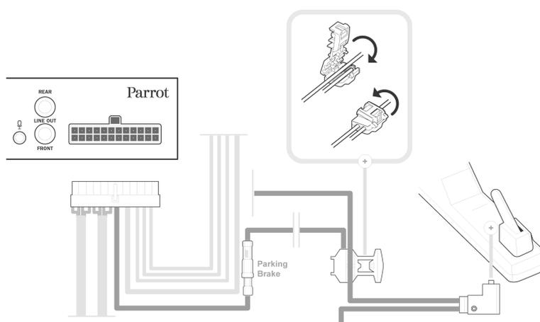
1. Collegare la prolunga del cavo del freno a mano fornita al cavo verde del Parrot ASTEROID Tablet (con l'indicazione Parking Brake).
