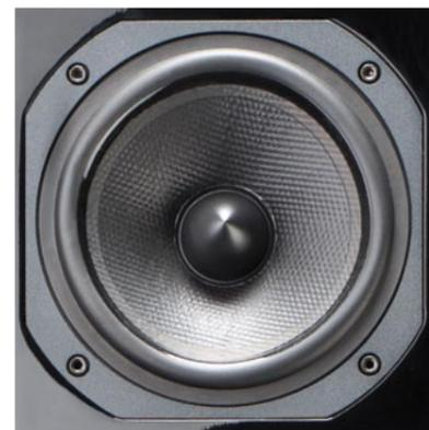
Per i coni dei mid-woofer abbiamo scelto il **Curv**: un materiale rigido, leggero e smorzato, realizzato con puro polipropilene estruso, tessuto e trattato termicamente. Il complesso magnetico è dotato di **Aluring**: un anello di corto circuito che riduce la non linearità tipica dei sistemi tradizionali, aumentando l'escursione controllata della bobina mobile.
