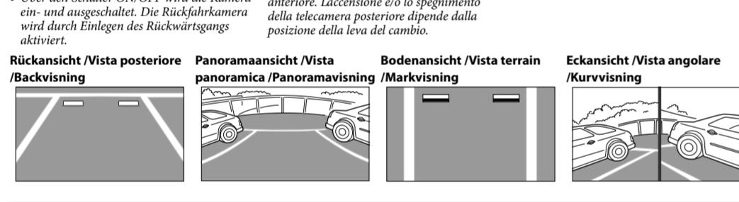
Einstellen des Kamerawinkels /Regolazione dell'angolazione della videocamera /Justera kameravinkel
