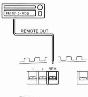
Collegate l'uscita remote dell'autoradio al morsetto [12] dell'amplificatore, con un piccolo cavo elettrico ( $1 \text{ mm}^2$ ).
