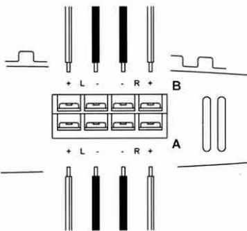
Collegate due sistemi di altoparlanti al connettore [15], rispettando le polarità.
