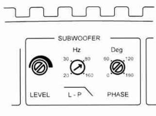
Regolate il controllo "L-P" [5] intorno ai 60÷100 Hz.
