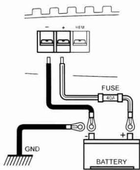
Collegate i morsetti d'alimentazione [11] **direttamente** alla batteria, **rispettando** le polarità. Utilizzate cavi di adeguata sezione ( $6 \text{ mm}^2$ ). Inserite un fusibile da 40 A, **vicino** alla batteria, sul cavo positivo, per proteggere la vettura. Il fusibile interno **non** sostituisce quello sulla batteria.
