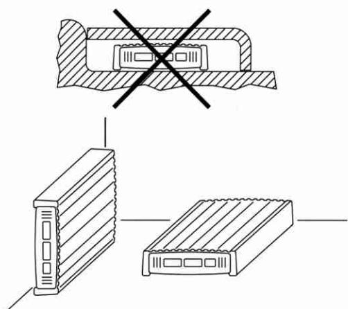
Per un funzionamento sicuro, posizionate l'amplificatore in un luogo **ben aerato** e protetto da polvere ed umidità. Ricordate che tutti gli amplificatori producono **calore** durante il funzionamento e forniscono le migliori prestazioni solo se correttamente raffreddati. Non installate l'amplificatore in un vano troppo piccolo per assicurare una buona aerazione.
