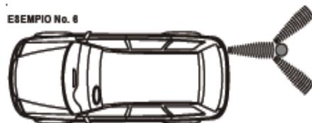
Il sistema potrebbe non rilevare un ostacolo di ridotte dimensioni (a.e. un palo).
