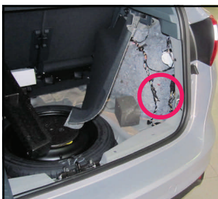
Vano bagagliaio: smontare la paratia, dietro la quale sono locati 3 connettori avvolti da una spugna
