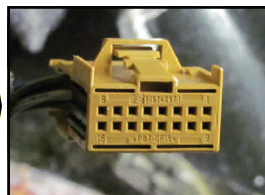
Estrarre i connettori dalla spugna ed individuare il connettore a 16 vie beige.
