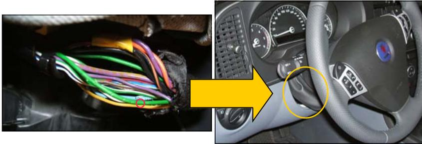
COLLEGARE IL CAVO **CAN H** DI MULTICAN AD UNO DEI DUE CAVI VERDI CHE SI TROVANO NEL FASCIO CAVI SOTTO LO STERZO.
