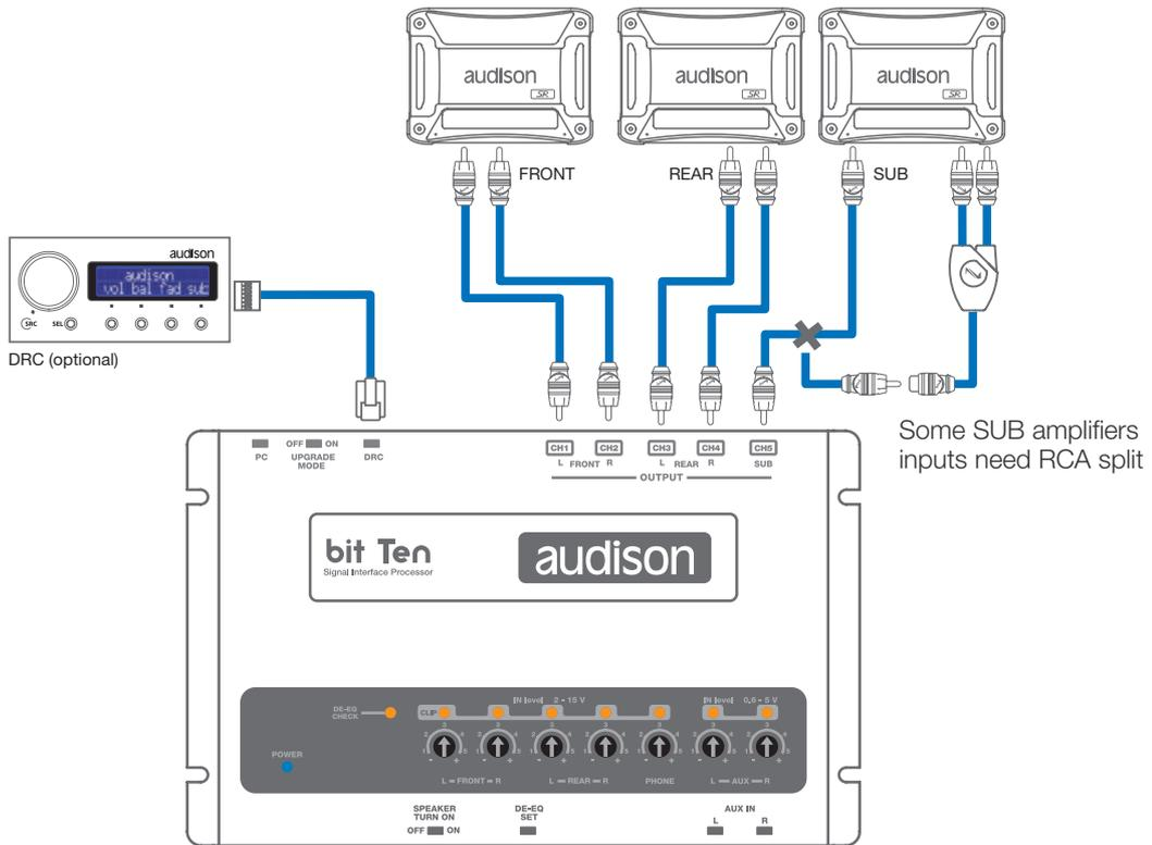
Esempio connessione di un sistema di amplificatori 2 vie front attivo + Sub ([vedi 8.2](#)).
