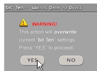
**ATTENZIONE:** Eseguire sempre **Finalize to bit Ten** prima di scollegare il **bit Ten** dal PC oppure ogni volta che si esce dal PC Software dopo che sono state apportate modifiche alla configurazione del sistema. Se questa operazione non viene effettuata tutti i dati immessi andranno perduti, verrà ripristinata la configurazione precedentemente memorizzata nel dispositivo.
