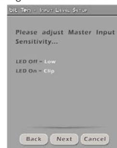
**Importante:** Molto spesso gli impianti audio installati di serie dalla casa costruttrice dell'auto hanno le uscite equalizzate. Questo significa che la curva di risposta non è piatta e l'escursione tra il punto più alto e quello più basso può raggiungere 6 dB. Se la taratura viene effettuata in modo che il LED non si accende mai, la sensibilità del bit Ten potrebbe risultare non ottimale (bassa) e si potrebbe avere del rumore (soffio) sugli altoparlanti.
