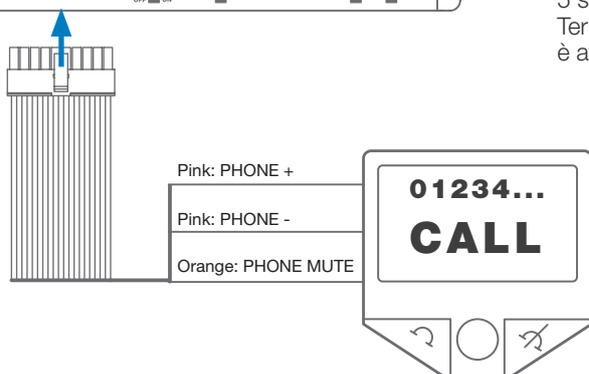
**PHONE +/-** Ingresso compatibile con l'uscita altoparlante del vivavoce (vedi 4.2.3). Sensibilità regolabile da 2V a 15V RMS.
