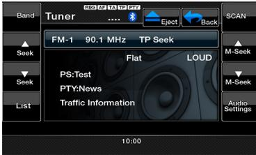
Toccare il tasto **[Band]** (Banda) oppure il pulsante **[Band]** (Banda) sul telecomando per selezionare la banda di frequenza della radio. Ogni volta che viene premuto il pulsante, la banda di ricezione radio viene cambiata nel seguente ordine: FM1, FM2, FM3, AM, FM1...
