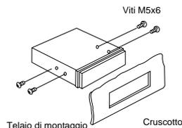
1. Inserire l'unità direttamente nell'apertura del cruscotto.
