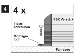
Halten Sie dann den Verstärker wieder an die zuvor gewählte Position und verschrauben Sie die Montagelöcher am Verstärker mit geeigneten Schrauben an den zuvor gebohrten Bohrlöchern mit dem Fahrzeug.
