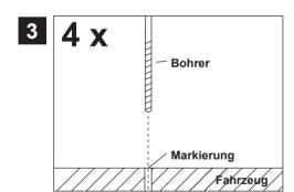
Legen Sie dann den Verstärker beiseite und bohren dann die Löcher für die Fixierschrauben an den zuvor markierten Punkten.
