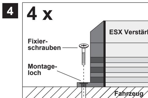
Halten Sie dann den Verstärker wieder an die zuvor gewählte Position und verschrauben Sie die Montagelöcher am Verstärker mit geeigneten Schrauben an den zuvor gebohrten Bohrlöchern mit dem Fahrzeug.
