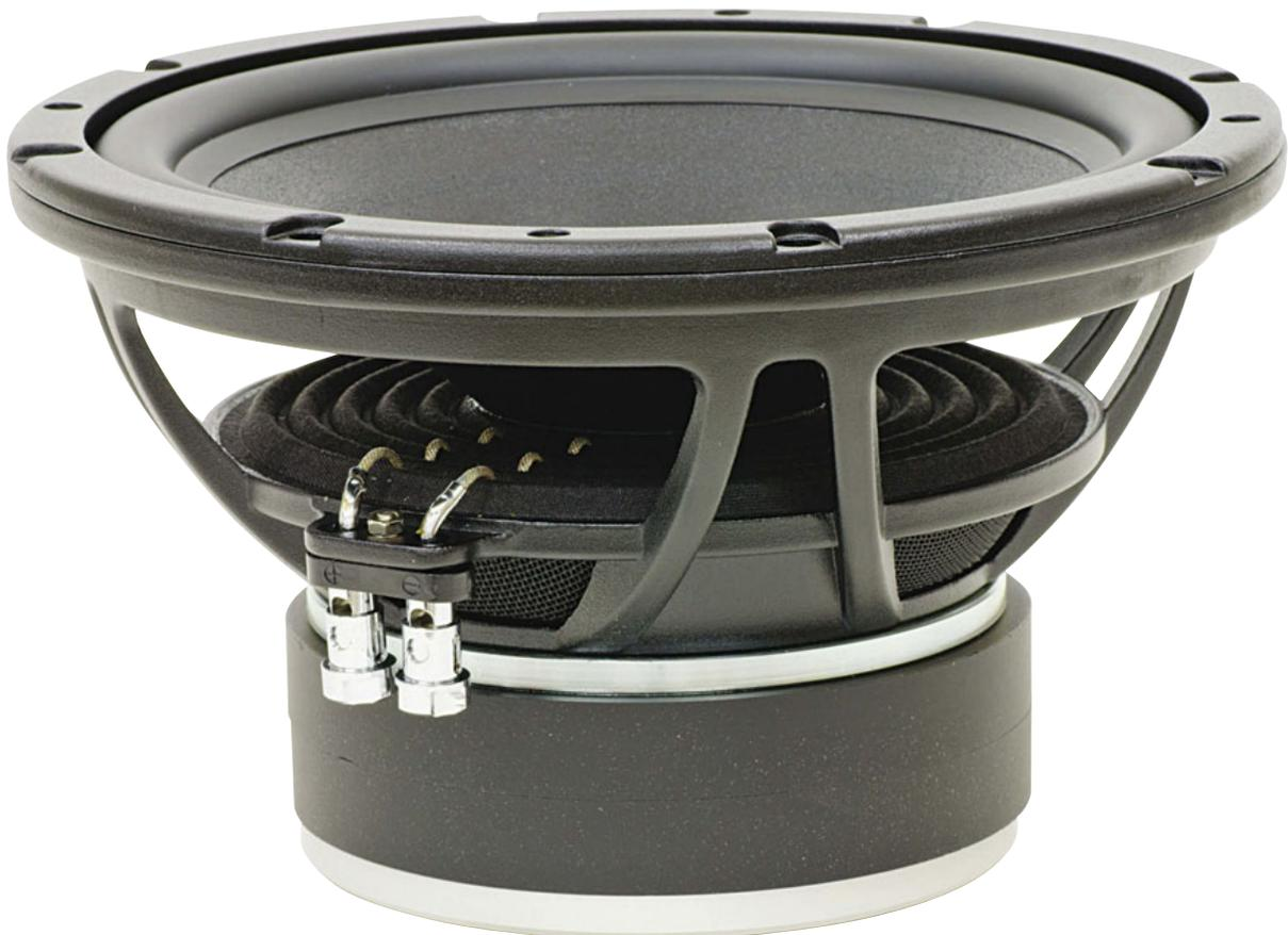
*Il cestello, in lega di alluminio, presenta delle razze opportunamente assottigliate per evitare ostacoli al suono ed agevolare l'aerazione della bobina mobile nella zona sotto al centratore. Questo funge anche da guida per i conduttori, letteralmente cuciti su di esso, che collegano la bobina ai morsetti d'ingresso.*
