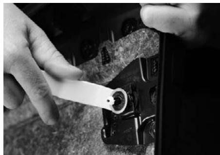
Repositionnement des agrafes en position "déverrouiller" avant de remonter la garniture de portière.
