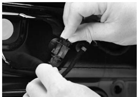
Remontage du support de tweeter focal et rebranchement de celui-ci (équipé du connecteur VW)
