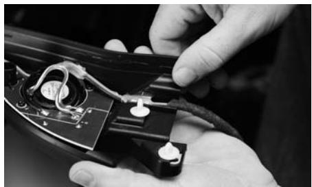
Repositionnement des deux agrafes plastiques sur le support du tweeter Focal.
