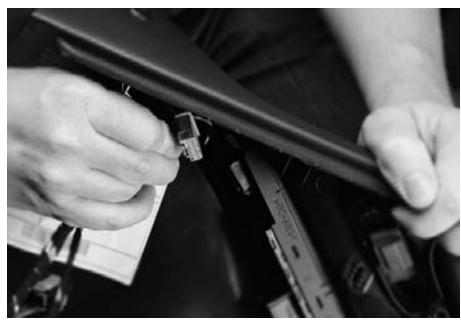
Débranchement des prises des connecteurs (lèves vitres multiplexage, rétroviseur ...)
