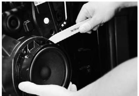
Perçage des rivets d'origine (x4 par woofer).
