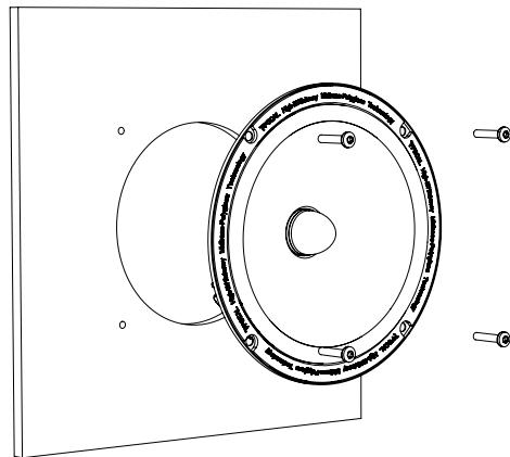
2/ Assemblage d'un woofer 2 voies ISS 570/690 dans un emplacement d'origine.
