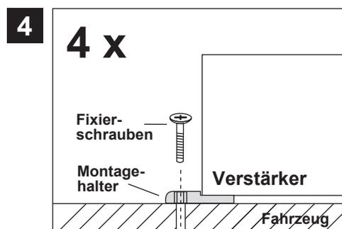
Halten Sie dann den Verstärker wieder an die zuvor gewählte Position und verschrauben dann den Verstärker an den vier noch freien Öffnungen der Montagehalter mit geeigneten Schrauben an den zuvor gebohrten Bohrlöchern am Fahrzeug. Achten Sie darauf, dass der verschraubte Verstärker fest sitzt und sich während der Fahrt nicht losvibriert. Danach bringen Sie die evtl. zuvor entfernten Guss-Endteile wieder an.
