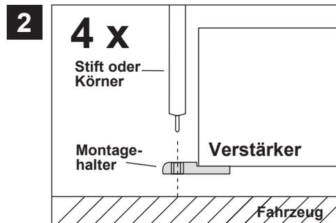
Halten Sie den Verstärker mit den vier angeschraubten Montagehaltern an die gewünschte Einbaustelle im Fahrzeug. Markieren Sie die vier Bohrlöcher mit einem geeigneten Stift oder Körner durch die vorgesehenen Löcher der Montagehalter. Achten Sie darauf, dass ausreichend Platz für die Installation der Kabel vorhanden ist und diese nicht geknickt werden sowie eine ausreichende Zugentlastung gewährleistet ist.
