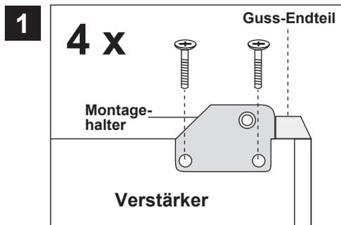
Vor dem Anbringen der Montagehalter können Sie zunächst die beiden Guss-Endteile an jedem Ende abschrauben. Montieren Sie dann die 4 beiliegenden Montagehalter an die Unterseite des Verstärkers mit den beiliegenden Schrauben und achten Sie darauf, dass die angewinkelte Seite des Montagehalters nach innen zeigt. Die vorgebohrten Gewindelöcher für die Montagehalter finden Sie jeweils an den vier Ecken des Verstärkers.
