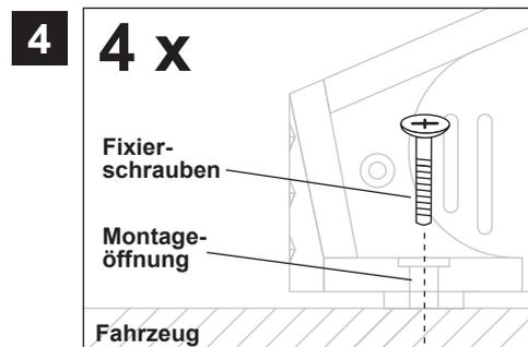
Halten Sie dann den Verstärker wieder an die zuvor gewählte Position und verschrauben Sie die Montageöffnungen am Verstärker mit geeigneten Schrauben an den zuvor gebohrten Bohrlöchern mit dem Fahrzeug.
