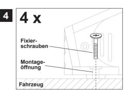
Halten Sie dann den Verstärker wieder an die zuvor gewählte Position und verschrauben Sie die Montageöffnungen am Verstärker mit geeigneten Schrauben an den zuvor gebohrten Bohrlöchern mit dem Fahrzeug.
