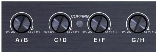
Nun drehen Sie den ersten Regler (Kanal A/B) langsam im Uhrzeigersinn bis die grüne Clipping-LED rot leuchtet. Anschließend drehen Sie den Regler wieder langsam so weit zurück, bis die LED wieder auf grün umschaltet und lassen den Regler auf dieser Position stehen. Der Kanal A/B ist nun richtig eingestellt. Wiederholen Sie diesen Vorgang nun für die nächsten Kanäle, bis alle Kanäle, die als Signaleingänge benutzt werden, fertig eingestellt sind.
