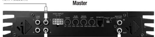
Im „Master-Modus“ (Schalter 15) übernimmt der Verstärker die komplette Regelung (Tiefpassfilter, Gain, Bass-Boost, Subsonic) für beide Endstufen und wird an den Plus-Lautsprecheranschluss angeschlossen. Die **MINUS**-Lautsprechklemmen der beiden Verstärker müssen direkt verbunden werden. Der empfohlene Kabelquerschnitt beträgt mindestens 6 mm<sup>2</sup>.
