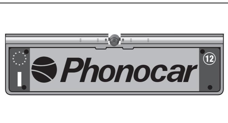
I - Installare la targa tramite le boccole fornite in dotazione.
