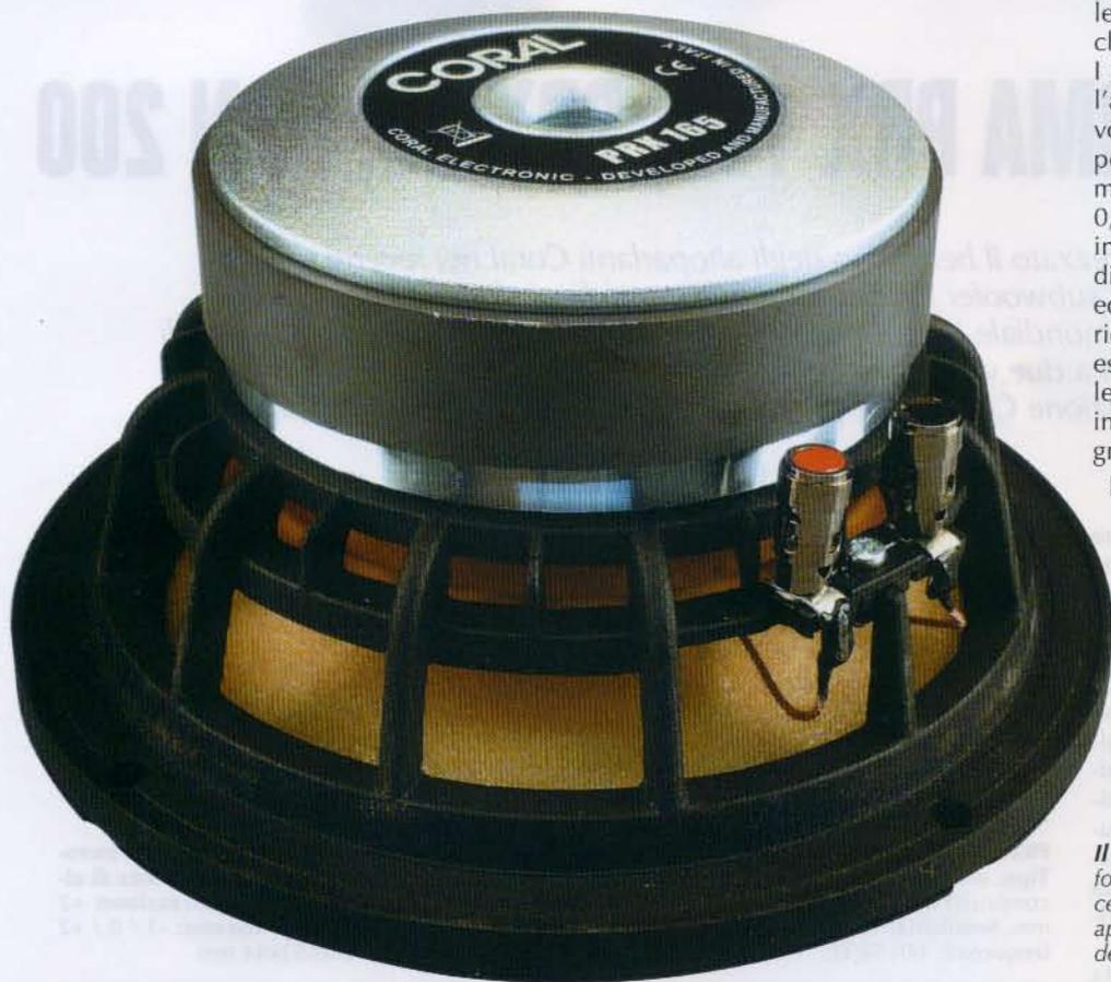
*Il PRX 165 è dotato di un bel magnete con foro di ventilazione, spessa piastra polare e cestello in pressofusione dalla struttura molto aperta per evitare ostacoli al passaggio dell'onda di pressione.*
