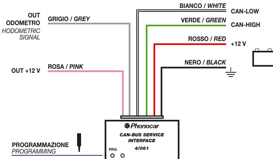
**I** - Effettuare i collegamenti, con l'inserimento del connettore nella centralina il led lampeggerà con colore rosso. Un programma ad auto apprendimento eseguirà la selezione del corretto protocollo.
